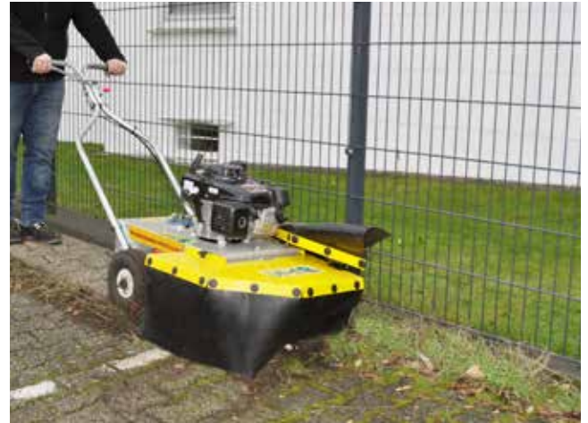
Schwadformer / Spritzschutz kann werkzeuglos angebracht werden.
