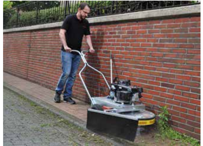
Schwadformer / Spritzschutz kann werkzeuglos angebracht werden.
